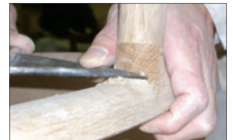
図8-7 量産化前のプロトタイプを手加工で調整していく
